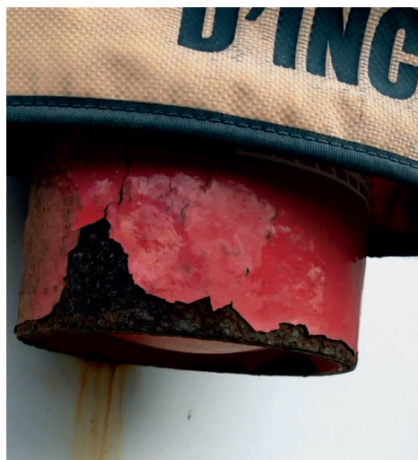
Un extincteur non protégé de façon adéquate et soumis aux aléas de la température est susceptible d'être attaqué par la corrosion.
