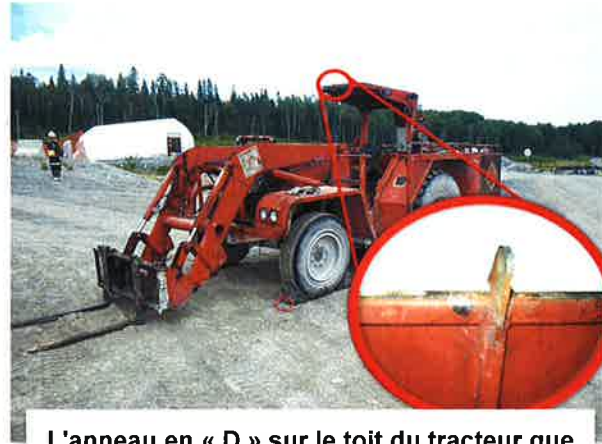
L'anneau en « D » sur le toit du tracteur que conduisait le travailleur lors de l'accident
